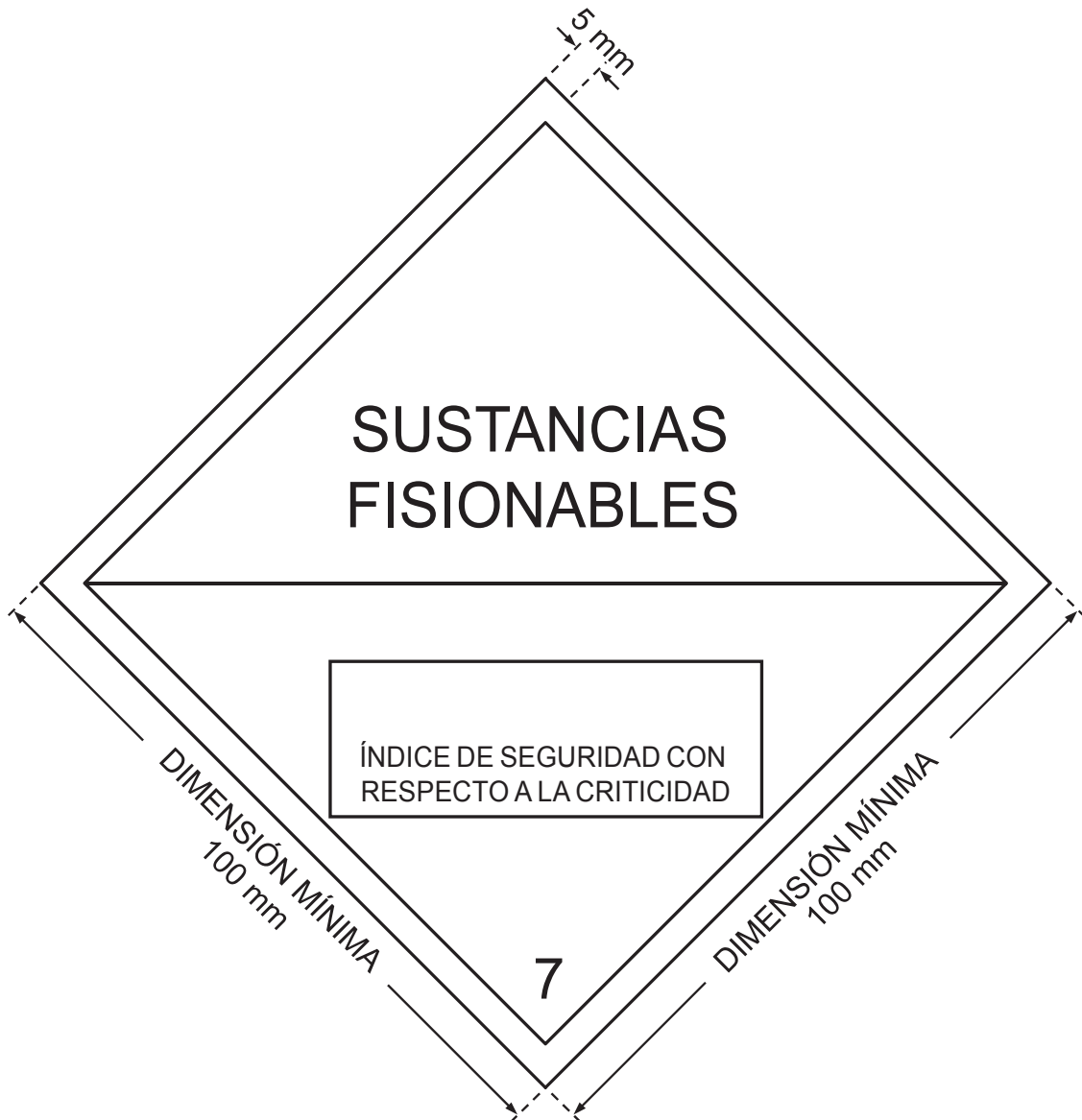
Fig. 5. Etiqueta para el ISC. El color de fondo de la etiqueta será blanco y los caracteres y líneas impresos serán negros.
